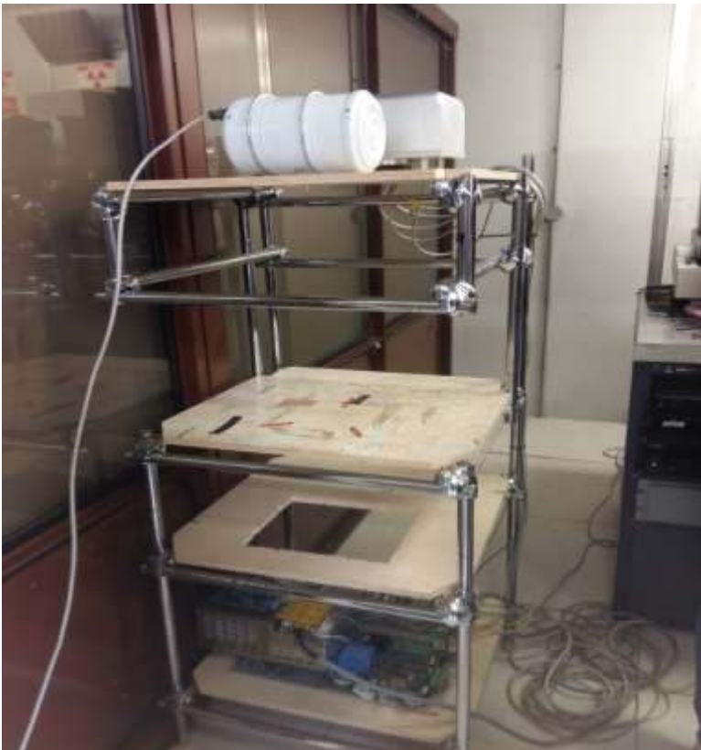
La struttura radiologica con il tubo attraverso cui passano i raggi x; i quali vengono poi proiettati sul corpo da prendere in esame.
