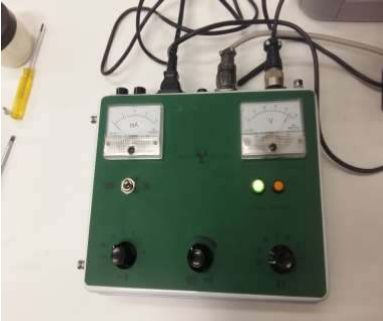
Generatore con sopra riportati kilovolt e milliampere.
