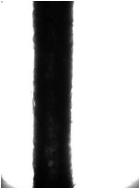
la parte centrale della spada - 69kilovolt in 5s
